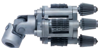
TIPO-5 Cabezal de brazo de ala con junta universal Rango: 1-3/4" (44.4 mm) - 13-1/4" (336.5 mm) Autoalimentación Depósito: 1/2" (12.7 mm) - grueso-duro a medio
