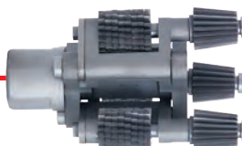
TYPE-4 Forward Swing Head Rango: 1-3/4" (44.4 mm) - 4 1/4" (120.6 mm) Autoalimentación Depósito: 1/2" (12.7 mm) grueso-duro a medio
